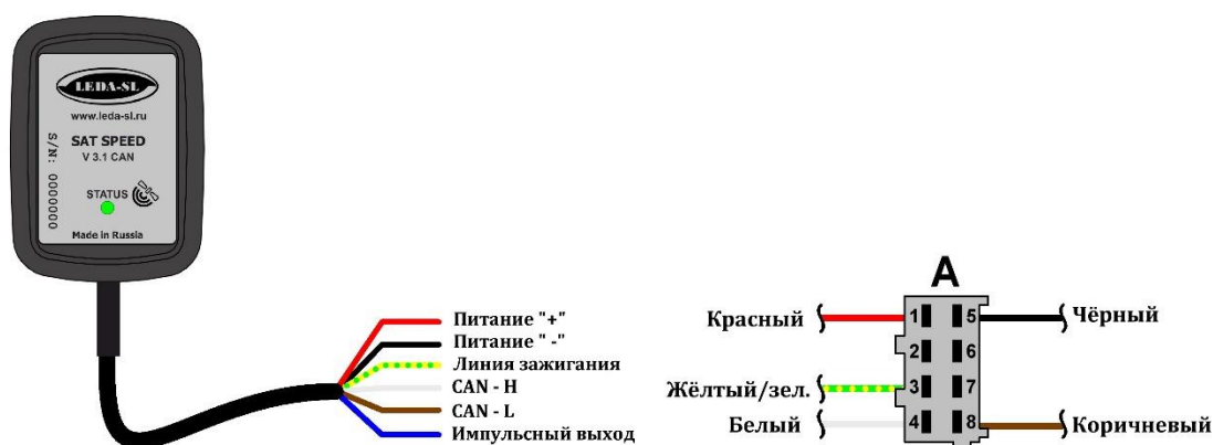
Рисунок 1. Схема подключение к коннектору «А» тахографа
