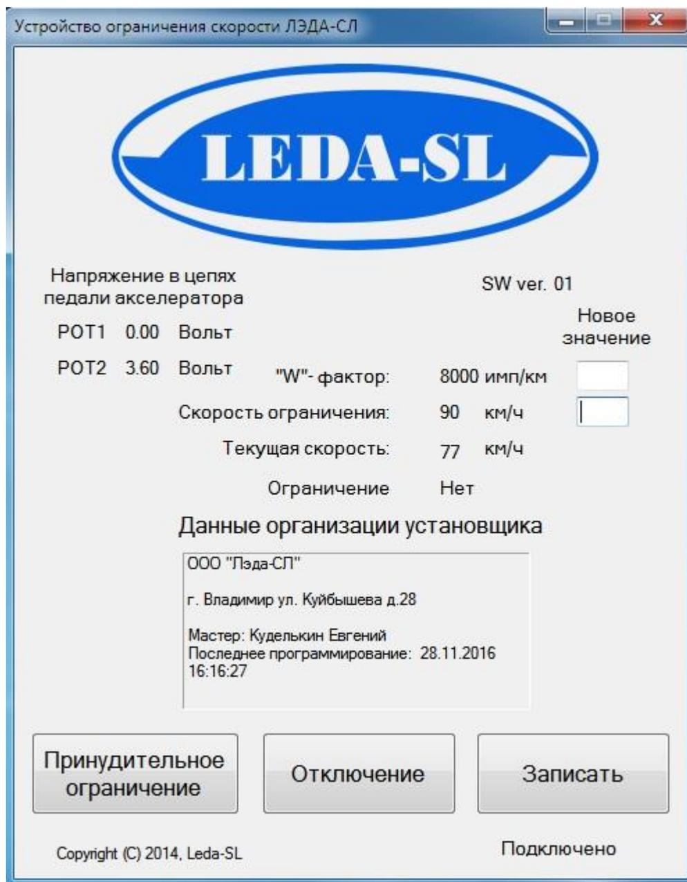
При программировании с помощью ПО, при записи значения скорости ограничения, приложение потребует ввести данные об организации и автоматически запишет дату и время последнего программирования. При программировании модуля с помощью средств для настройки и калибровки тахографов эти данные в память не сохраняются (стираются) !
