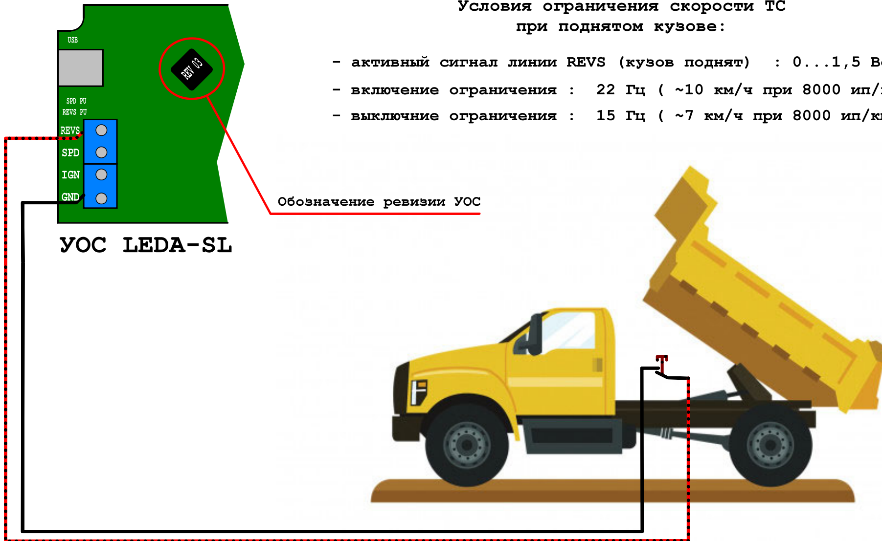
Схема подключения датчика поднятия кузова
